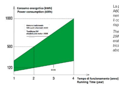
La potenza in entrata di un motore a poli schermati tradizionale A600 è 29W, la potenza in entrata di un EC05 è 5,4 W; supponendo che il motore funzioni 24 ore/giorno e 365 giorni/anno e il costo per l'energia elettrica è 0,23 euro/kWh, ogni EC05 può risparmiare, in elettricità, circa 45 euro l'anno.
